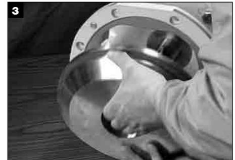
Déposez le boîtier de la garniture mécanique de l'équipement.
